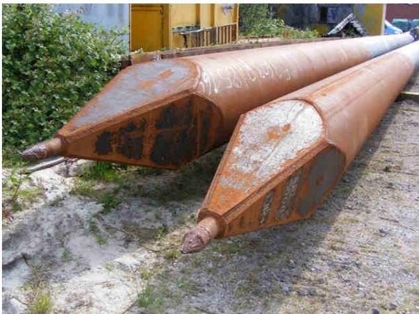
**Die neuen Dalben werden mit Stahlspitzen versehen, um auch durch den bestehenden Kolkenschutz eingebracht werden zu können.**
